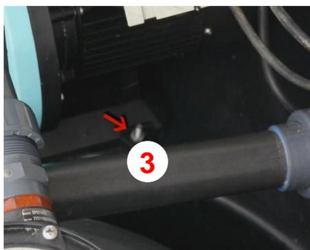
Dévissez l'écrou de fixation ③ de la pompe.
