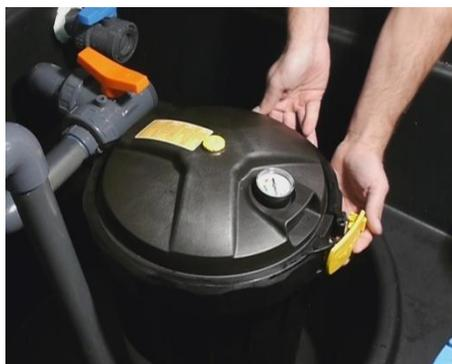
Mettez en place le couvercle et le collier de serrage du filtre.
