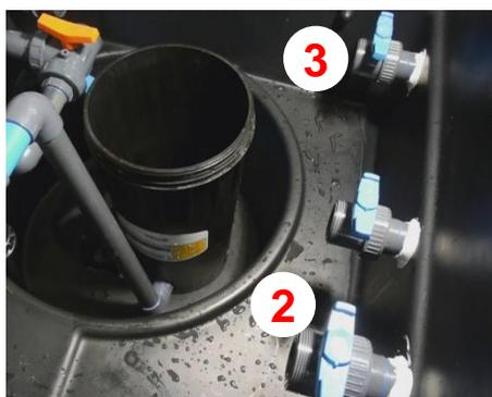
Fermez la vanne d'aspiration (2) et la vanne de refoulement (3).
