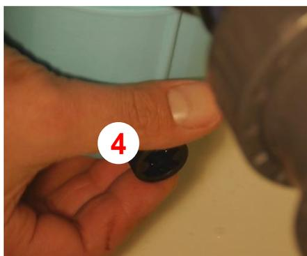
Dévissez le bouchon de vidange ④ situé sur le préfiltre de la pompe.
