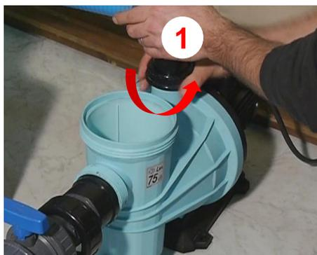
Dévissez le raccord de sortie ① de la pompe.
