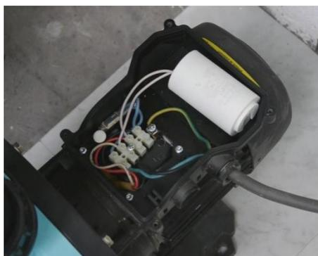
Retirez le couvercle du boîtier de raccordement de la pompe.
